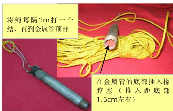
基本的地下水位监测仪器
